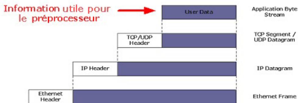
Figure 7-6 - Encapsulation des données en TCP/IP
