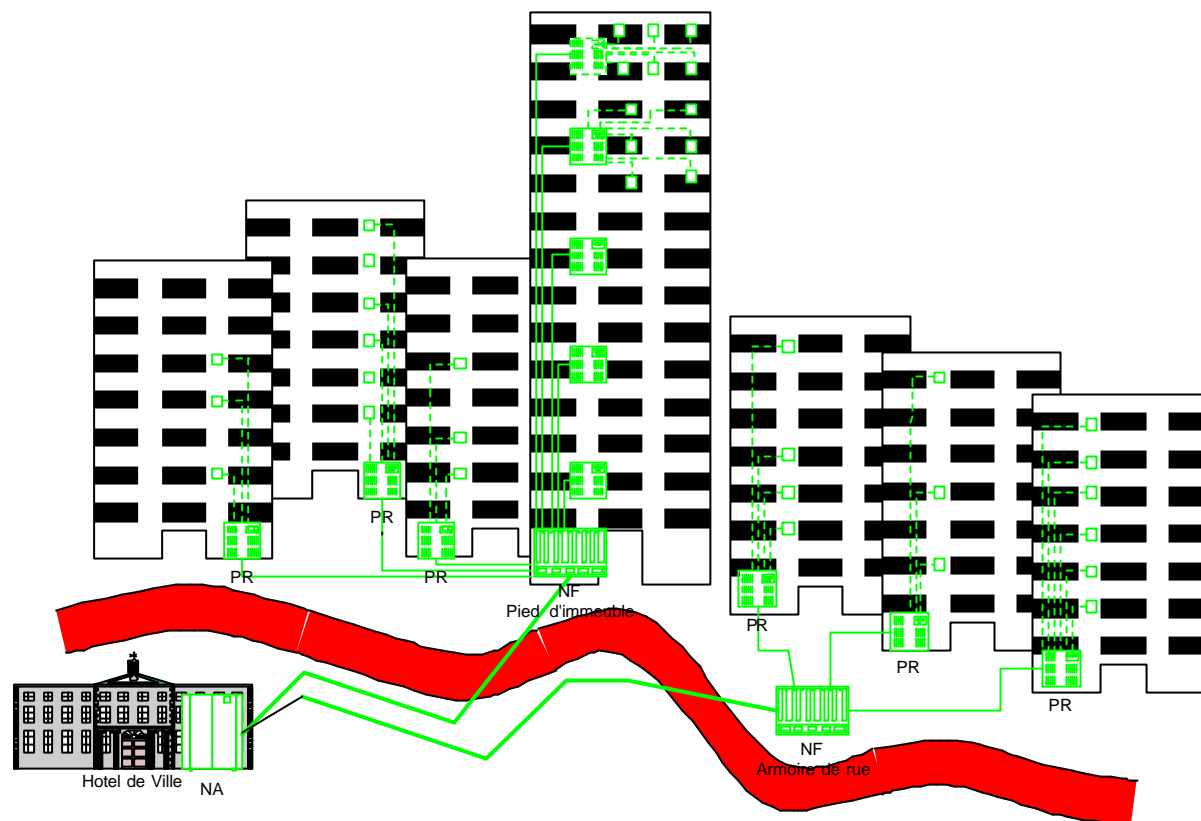
Figure 9.15 : Architecture de desserte en habitat urbain dense
