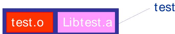
Le linkage d'une librairie statique avec un binaire est identique au linkage d'un fichier objet.
